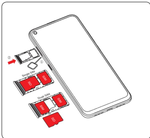
Pour pouvoir effectuer des appels, vous devez avoir inséré une carte SIM. Grâce à la capacité de remplacement à chaud de votre appareil, il n'est pas nécessaire de l'éteindre avant d'insérer ou de retirer la carte SIM.
